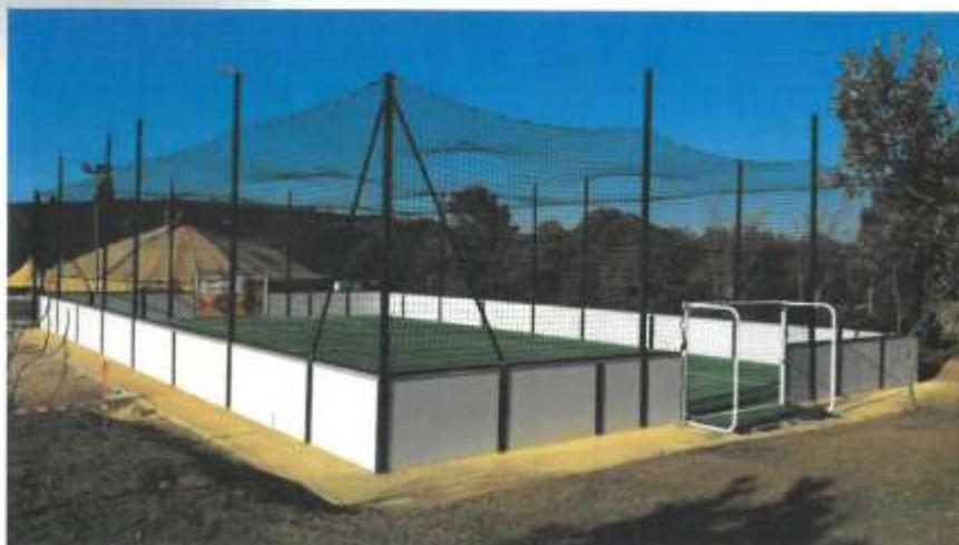
**Buts 4 x 2 m galvanisé et plastifié blanc RAL 9010 Ø 80mm avec jonction aluminium ;**
